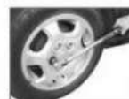
в. С помощью динамометрического ключа убедиться, что гайка закручена с требуемым усилием.
